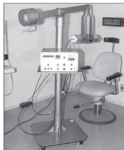
Figura 3. Sonda cintilométrica SCT-13004 do Serviço de Medicina Nuclear do HUCFF-UFRJ.
