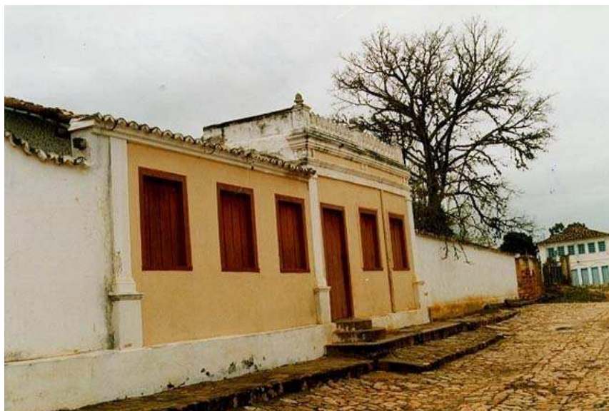
FIGURA 12- Aspectos do casario e arruamento de pedra. Detalhe da foto a presença de eira e beira na casa em destaque. Foto: José Dourado.
