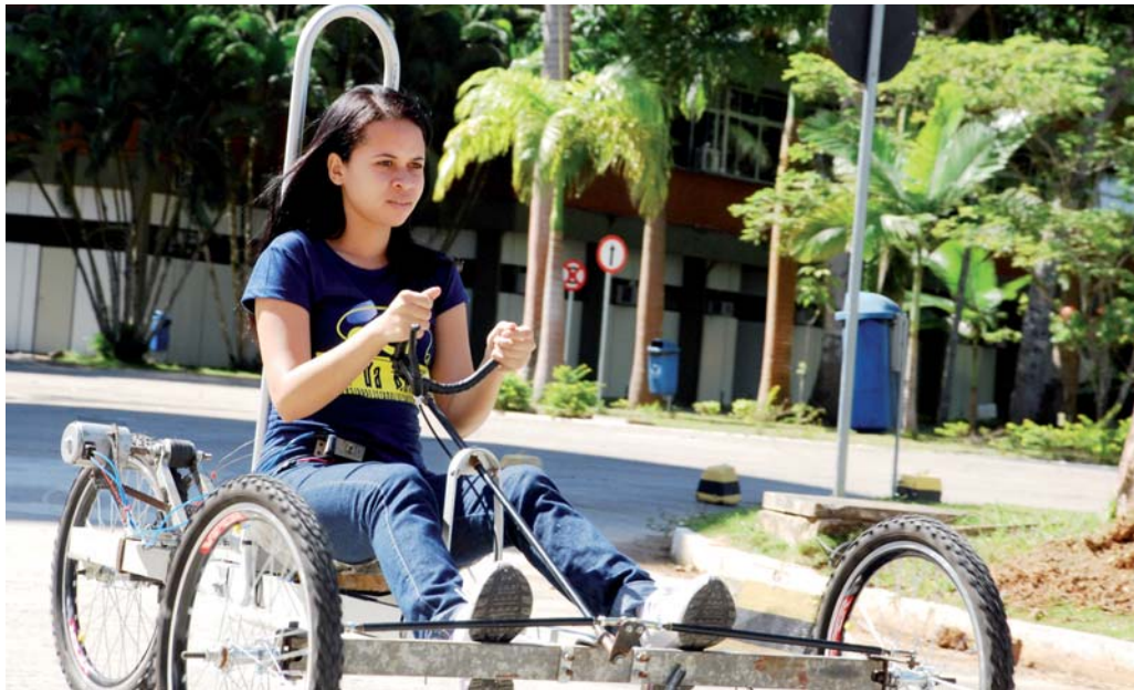
Carro sendo testado ainda sem carenagem
